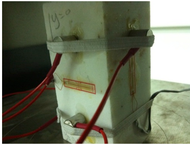
Σχήμα 1. Πειραματική διάταξη και τοποθέτηση αισθητήρων ΑΕ
